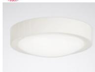
Hublot avec système LED. Pour montage au mur ou au plafond. Avec vasque opale de PC, résistante aux chocs. Flux lumineux du luminaire 1450 lm, puissance raccordée 16 W,
