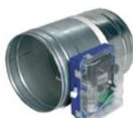
Clapet coupe-feu circulaire 2h ISONE + EM Ø 450 mm configuré. Fusible 70°C. Clapet "multi positions" : scellé en dalle ou en mur sans fixation ni suspension. Axe de la lame horizontal ou
