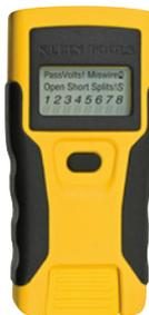
Test de continuité de connexion de câblage informatique à paires torsadées (RJ45). Le générateur de tonalité intégré supporte plusieurs tonalités et commande plusieurs bornes qui transmettent la tonalité. Les ports robustes ont été conçus pour un usage intensif et des connexions répétées. Boîtier solide et ergonomique pour une utilisation pratique.
