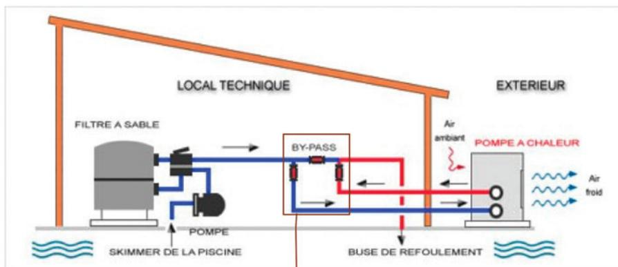
Kit By-pass à raccorder sur l'installation existante.
