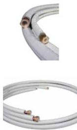
Bi-tube avec raccords flare et pré-dudgeonné, bouchonné, 4 écrous SAE sont fournis montés. Isolant de 10 mm d'épaisseur composé de 3 couches de polyéthylène expansé à cellules fermées. Conductivité thermique à 0°c ≤ 0. 037 W/m²K. Température d'utilisation : de. 40°c à + 110°c. Pellicule extérieure en PE extrudé, anti-rupture. Aspect extérieur : gris clair.
