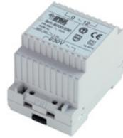
Transformateur de sécurité 230V/12Vca-1,1A 18VA. Boîtier modulaire 3 modules pour montage rail DIN ou fixation murale. Protection électronique par PTC. Conforme aux normes CEI. Dimensions : (HxLxP) : 60 x 53 x 85 mm.
