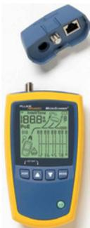
Testeur de qualification qui permet de dépanner et de certifier le débit de câblage cuivre (10/100/1 000/VoIP). Fonctionne sur les réseaux en cours d'exploitation afin de fournir la détection des commutateurs Ethernet et la configuration du périphérique. Mesure capacité du réseau (10 Mg, 100 Mg, 1 Gig) pour déterminer la prise en charge de la VoIP, des données et de la vidéo. Diagnostics de
