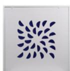
Diffuseur Mid NEXT-KLIN 600L I système PUSH KLIN, en acier galvanisé laqué blanc à segments de diffusion fixes et en couleur, garantissant un fort taux d'induction. Utilisable dans les locaux de 2,5 à 4 m de hauteur. Monté sur plénum
